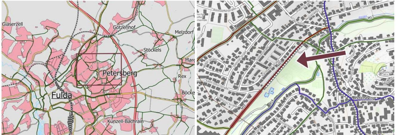
**IST-Zustand:** Bergab Richtung Fulda existieren keine Radverkehrsanlagen. Die Radfahrer werden auf der Fahrbahn geführt. Bergauf werden die Radfahrer auf einem benutzungspflichtigen zu schmalen gemeinsamen Geh- und Radweg geführt.
