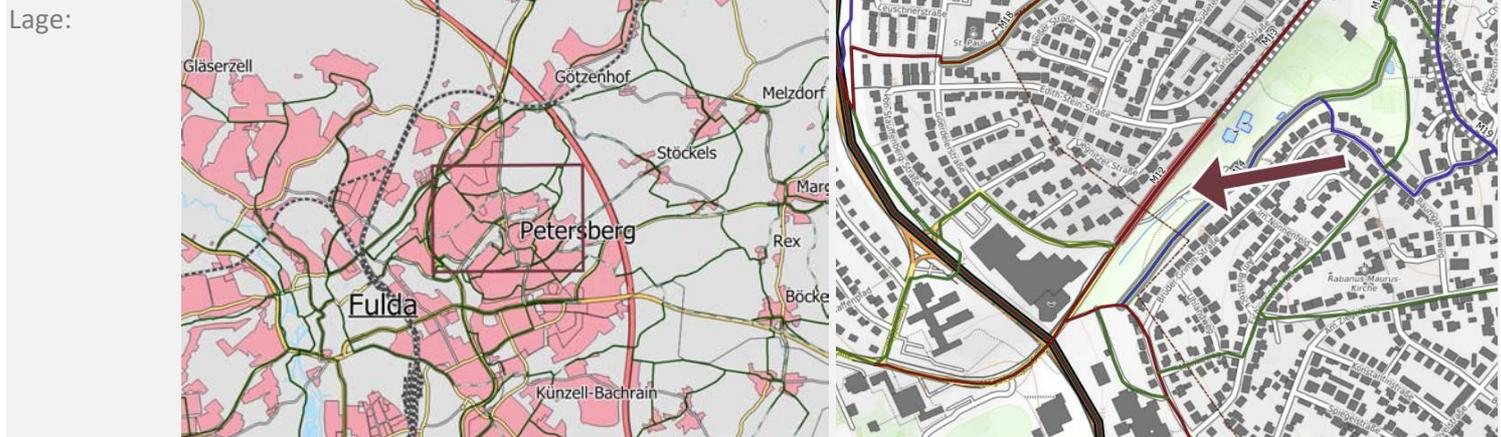
**IST-Zustand:** Richtung Fulda / bergab besteht ein Schutzstreifen, der ohne Sicherheitstrennstreifen unmittelbar an den parkenden Autos vorbeiführt. Richtung Petersberg Ortsmitte / bergauf wird der Radverkehr auf einem zu schmalen, benutzungspflichtigen Geh- und Radweg geführt.
