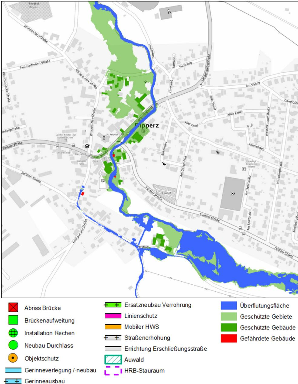
**Abbildung 11-32: Überflutungsfläche HQ100 für Grundvariante 1 in Dipperz**
