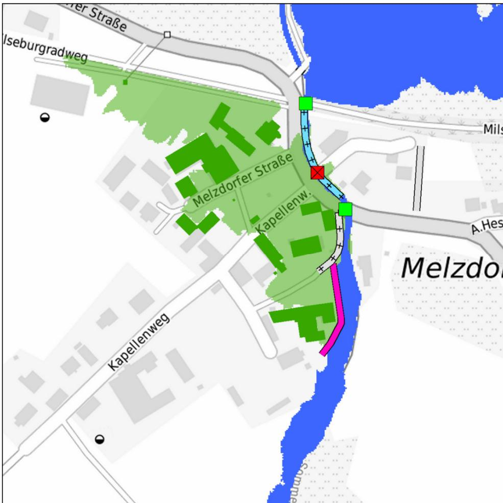
**Abbildung 11-9: Überflutungsfläche HQ100 für Grundvariante 2 in Melzdorf**
