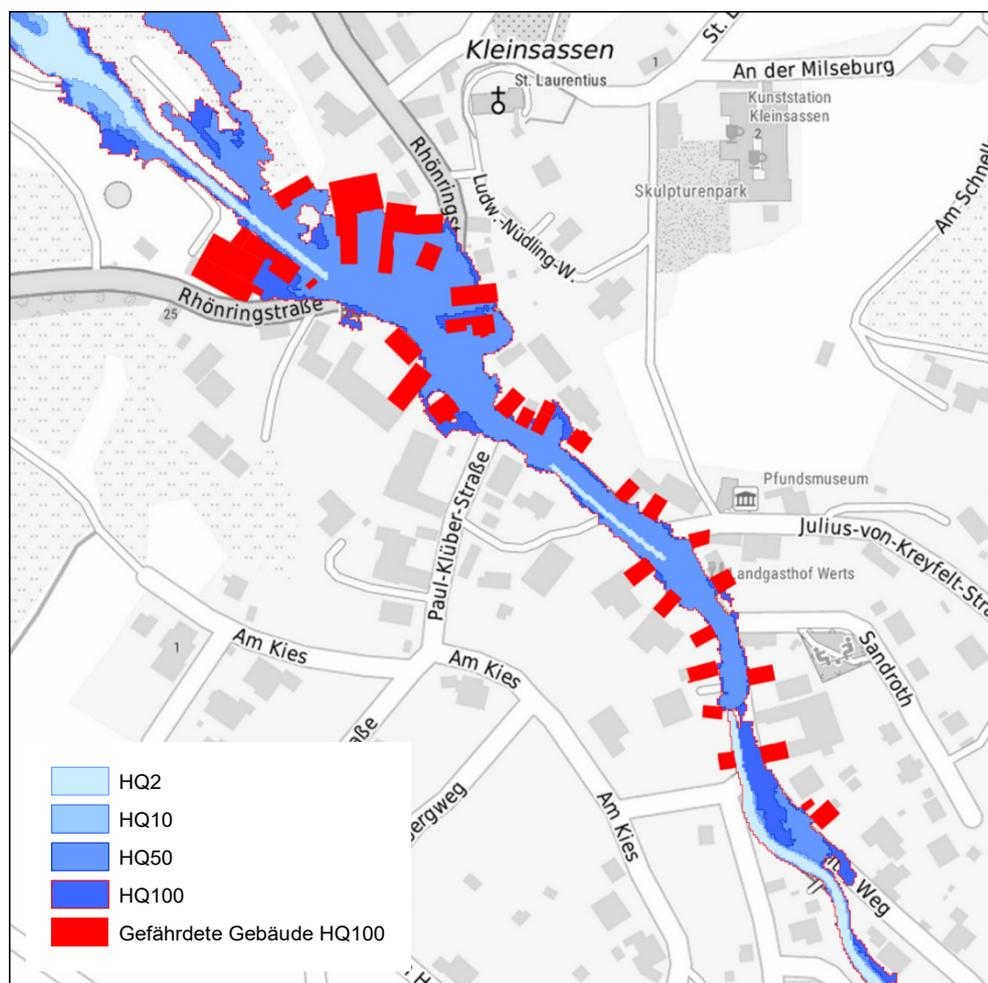
**Abbildung 11-51: Überflutungsflächen HQ(T) für den Istzustand in Kleinsassen**
