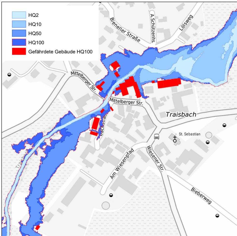
**Abbildung 11-56: Überflutungsflächen HQ(T) für den Istzustand in Traisbach**
