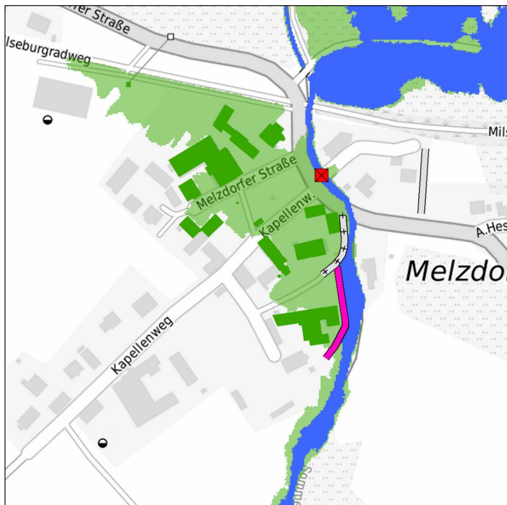
**Abbildung 11-10: Überflutungsfläche HQ100 für die Vorzugsvariante in Melzdorf**
