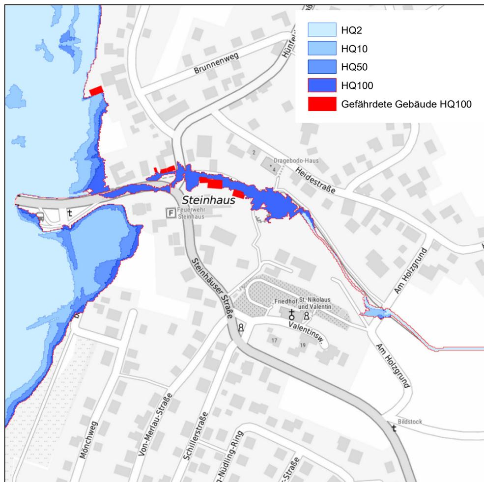
**Abbildung 11-1: Überflutungsflächen HQ(T) für den Istzustand in Steinhaus**
