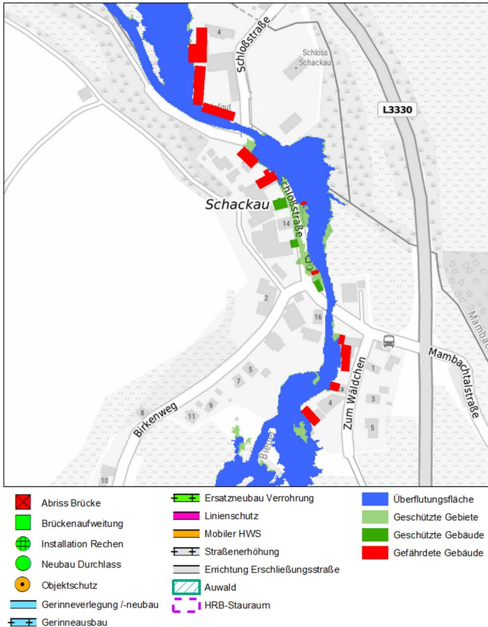
**Abbildung 11-48: Überflutungsfläche HQ100 für Grundvariante 1 in Schackau**
