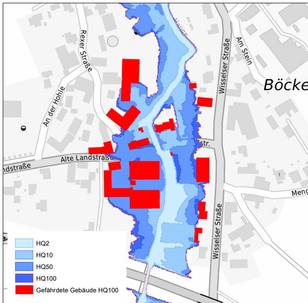
**Abbildung 11-18: Überflutungsflächen HQ(T) für den Istzustand in Böckels**
