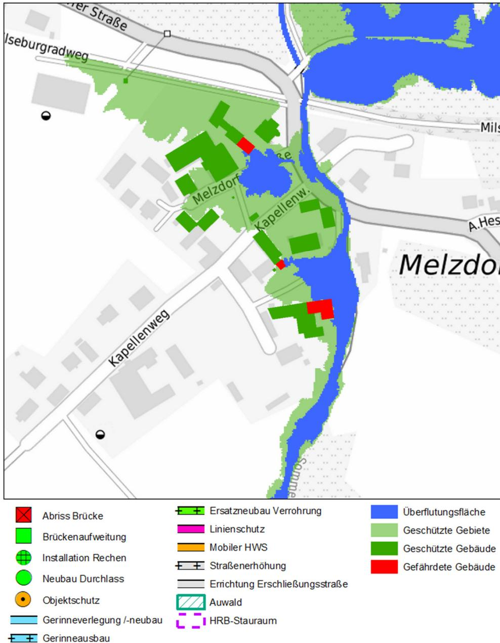
**Abbildung 11-8: Überflutungsfläche HQ100 für Grundvariante 1 in Melzdorf**
