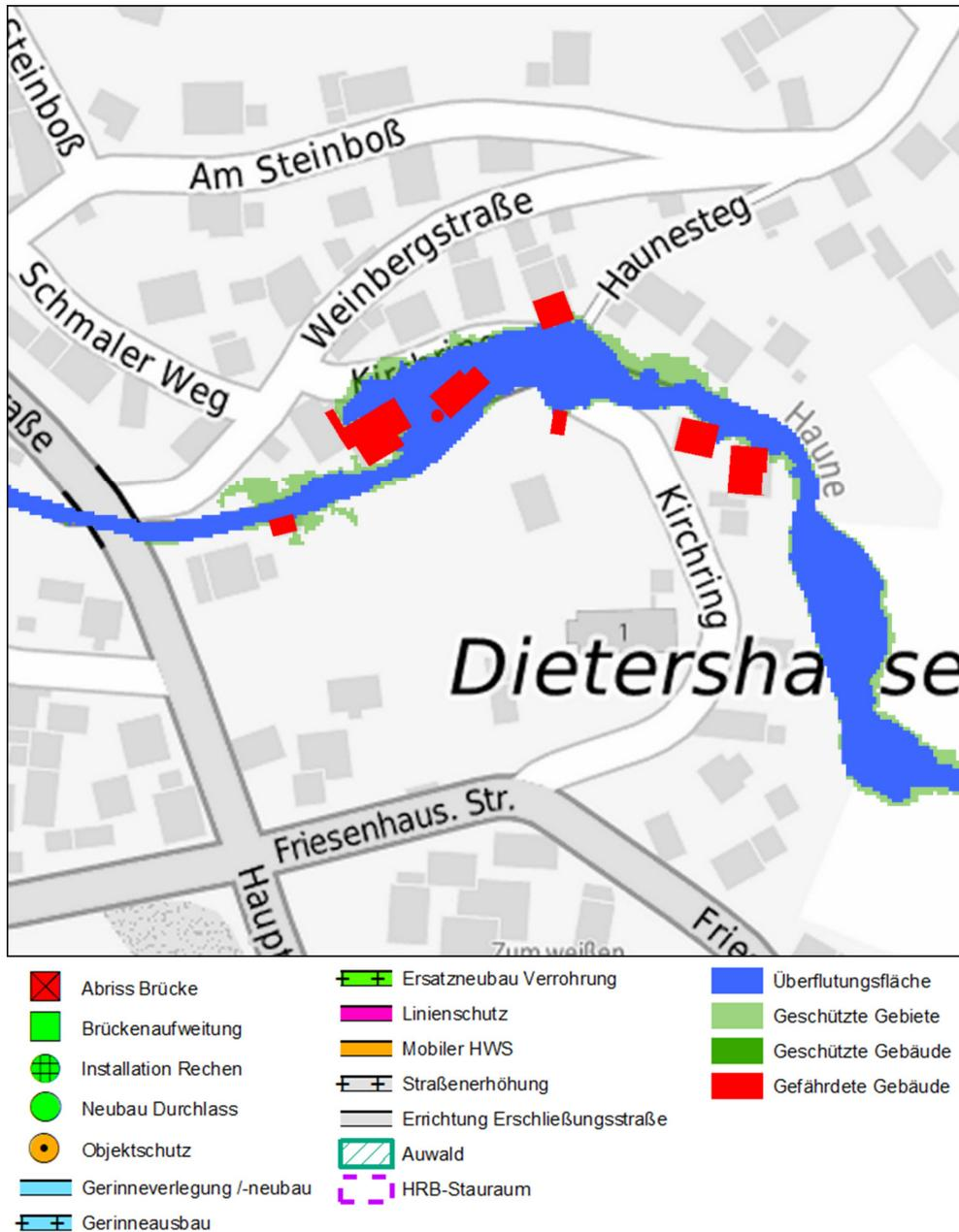
**Abbildung 11-29: Überflutungsfläche HQ100 für Grundvariante 1 in Dietershausen**
