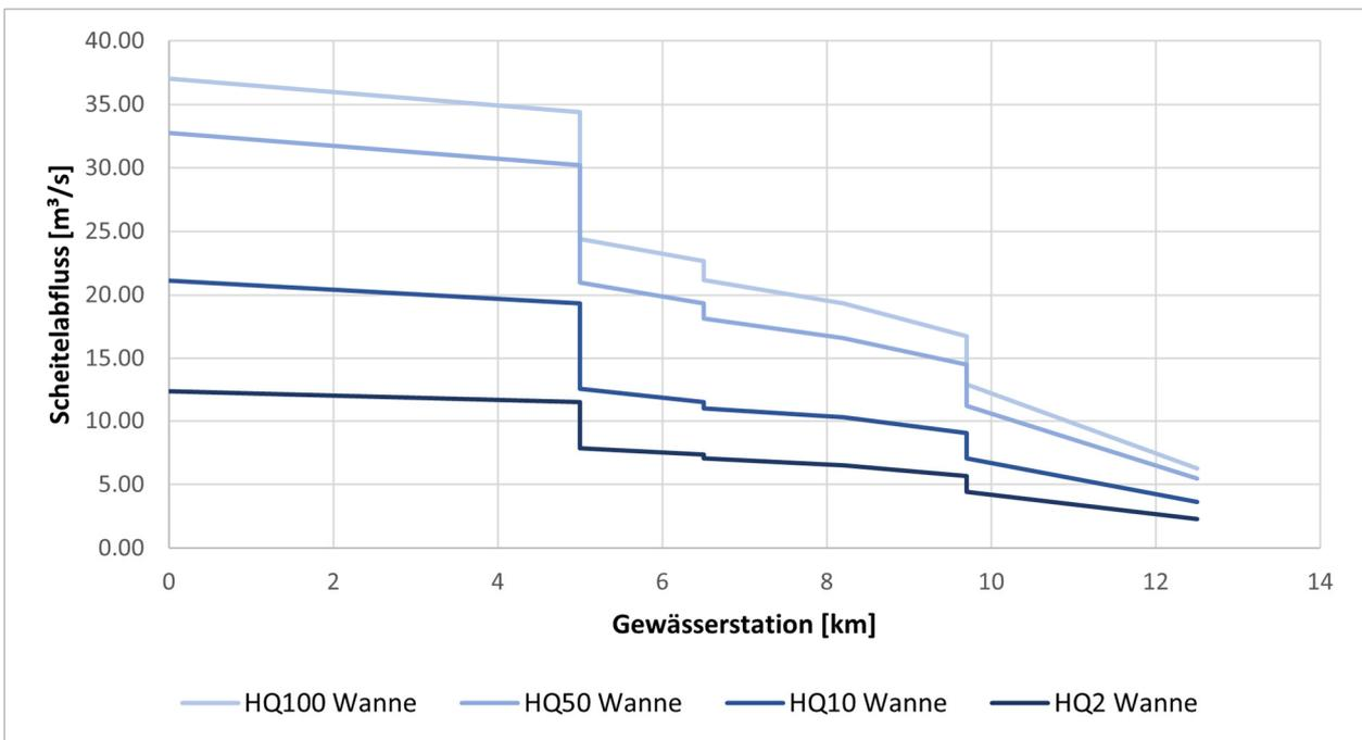
Abbildung 6-8: Hydrologischer Längsschnitt für die Wanne im Istzustand
