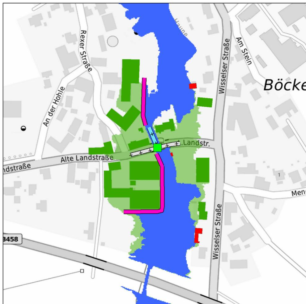
**Abbildung 11-20: Überflutungsfläche HQ100 für Grundvariante 2 (Vorzugsvariante) in Böckels**
