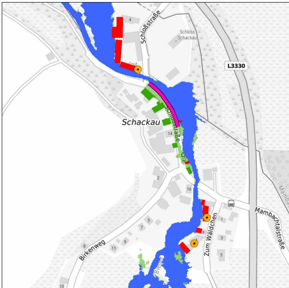
**Abbildung 11-50: Überflutungsfläche HQ100 für die Vorzugsvariante in Schackau**
