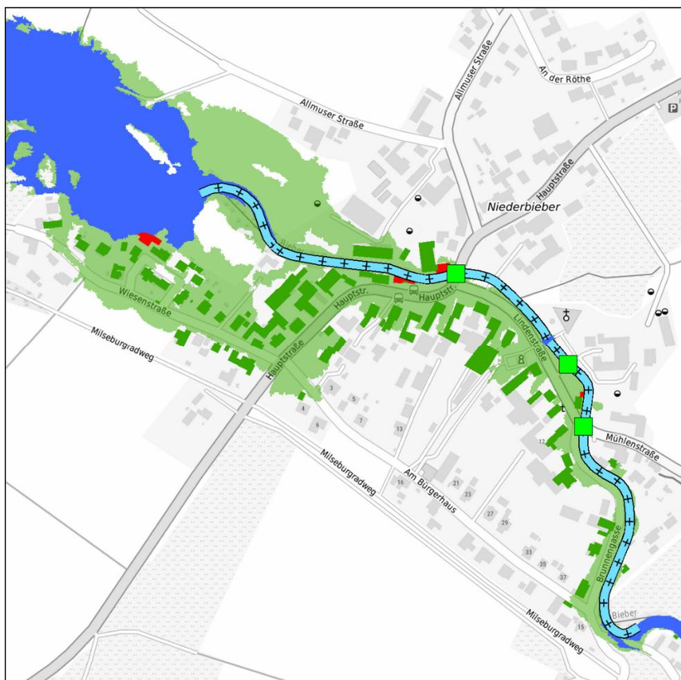
**Abbildung 11-42: Überflutungsfläche HQ100 für die Vorzugsvariante in Niederbieber**
