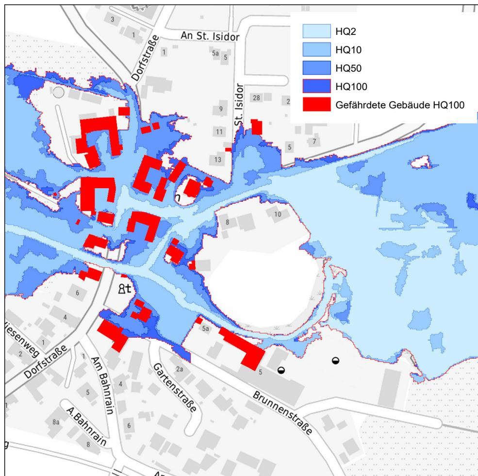
**Abbildung 11-35: Überflutungsflächen HQ(T) für den Istzustand in Wiesen**
