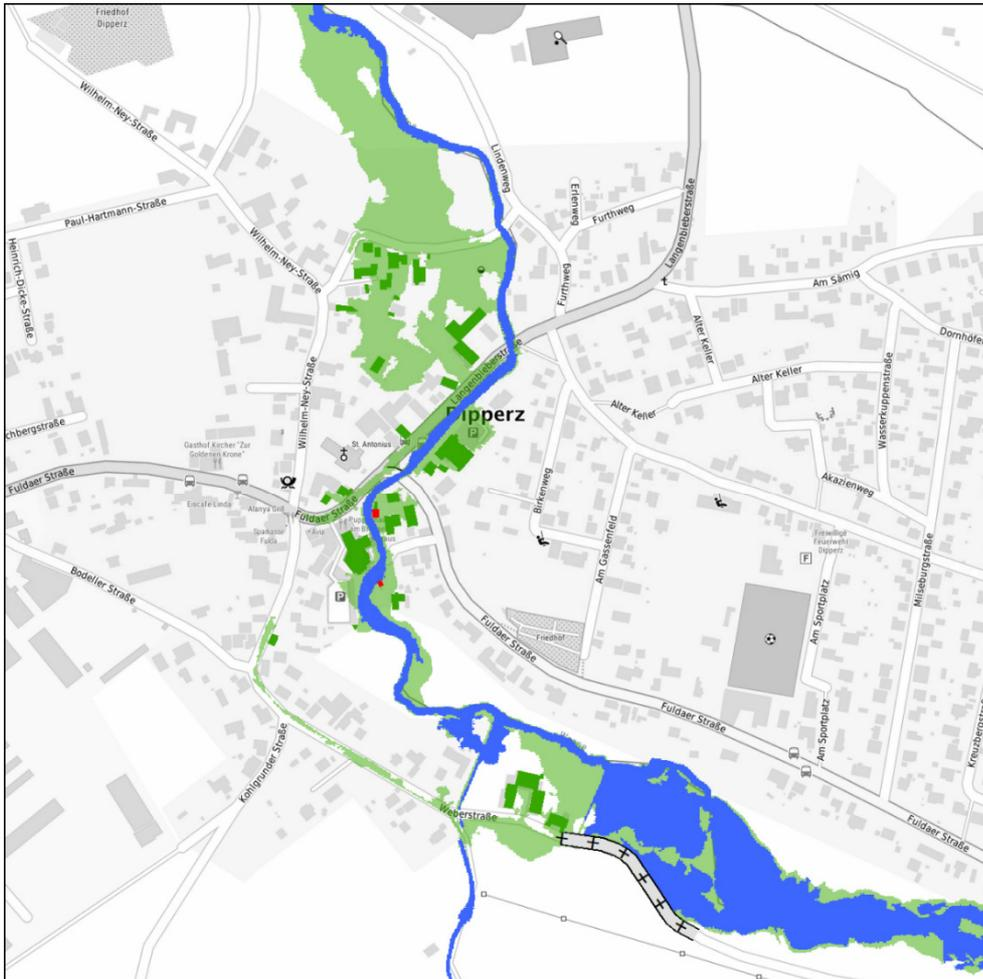
**Abbildung 11-34: Überflutungsfläche HQ100 für Vorzugsvariante in Dipperz**
