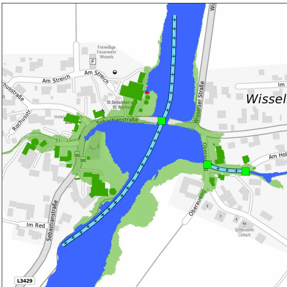
**Abbildung 11-24: Überflutungsfläche HQ100 für die Vorzugsvariante in Wissels**
