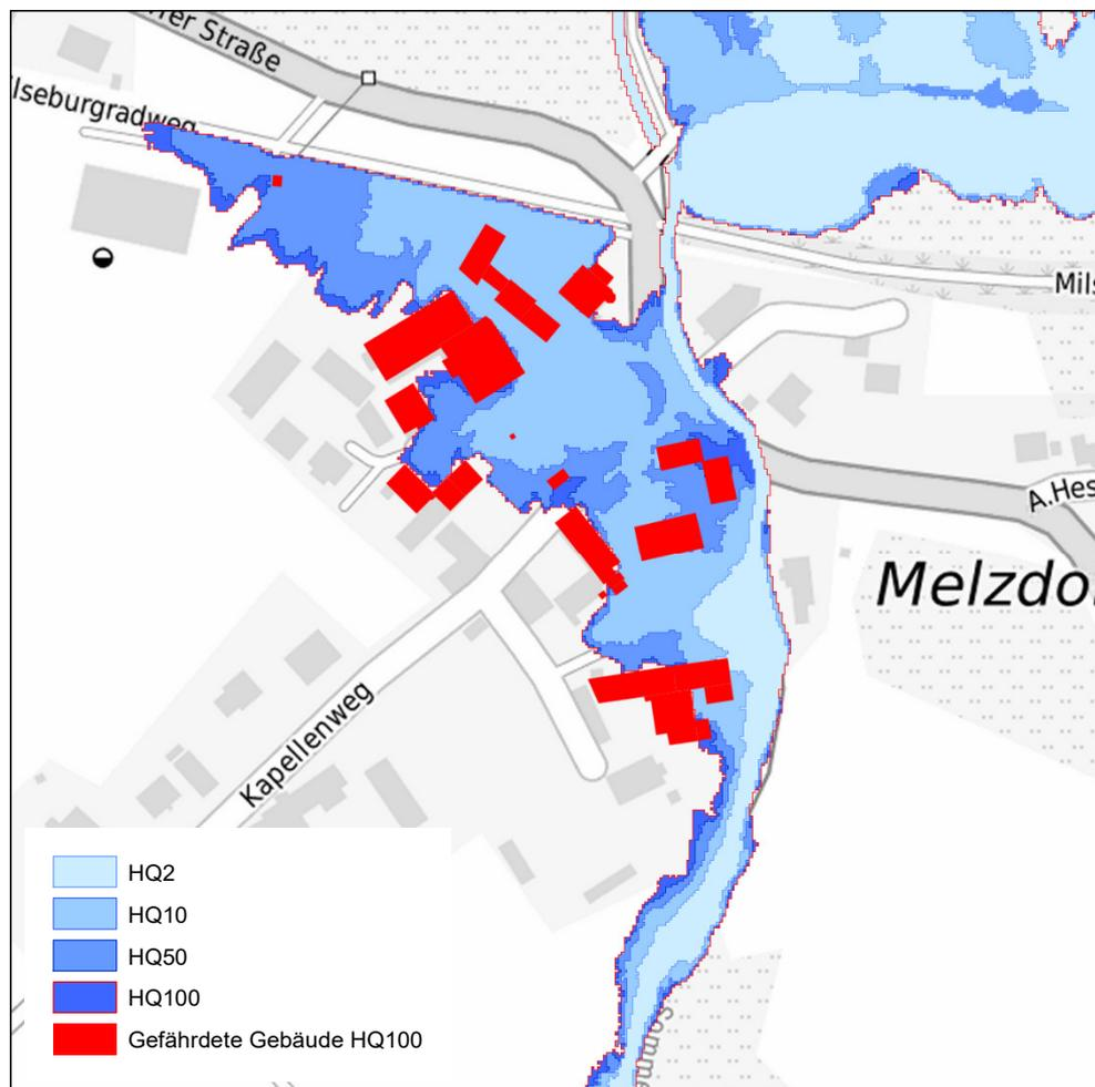
**Abbildung 11-7: Überflutungsflächen HQ(T) für den Istzustand in Melzdorf**
