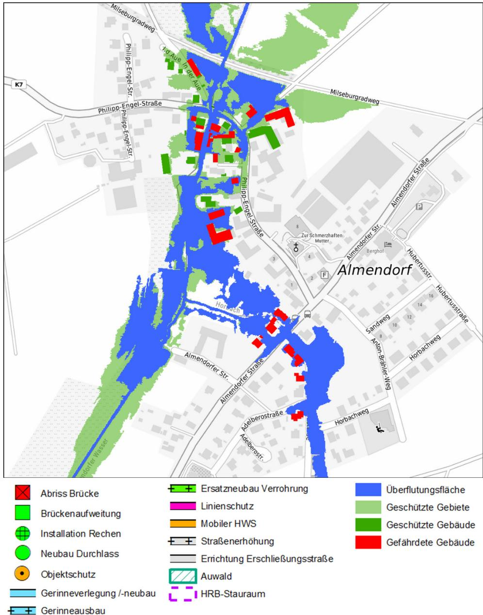
**Abbildung 11-5: Überflutungsfläche HQ100 für Grundvariante 1 in Almendorf**
