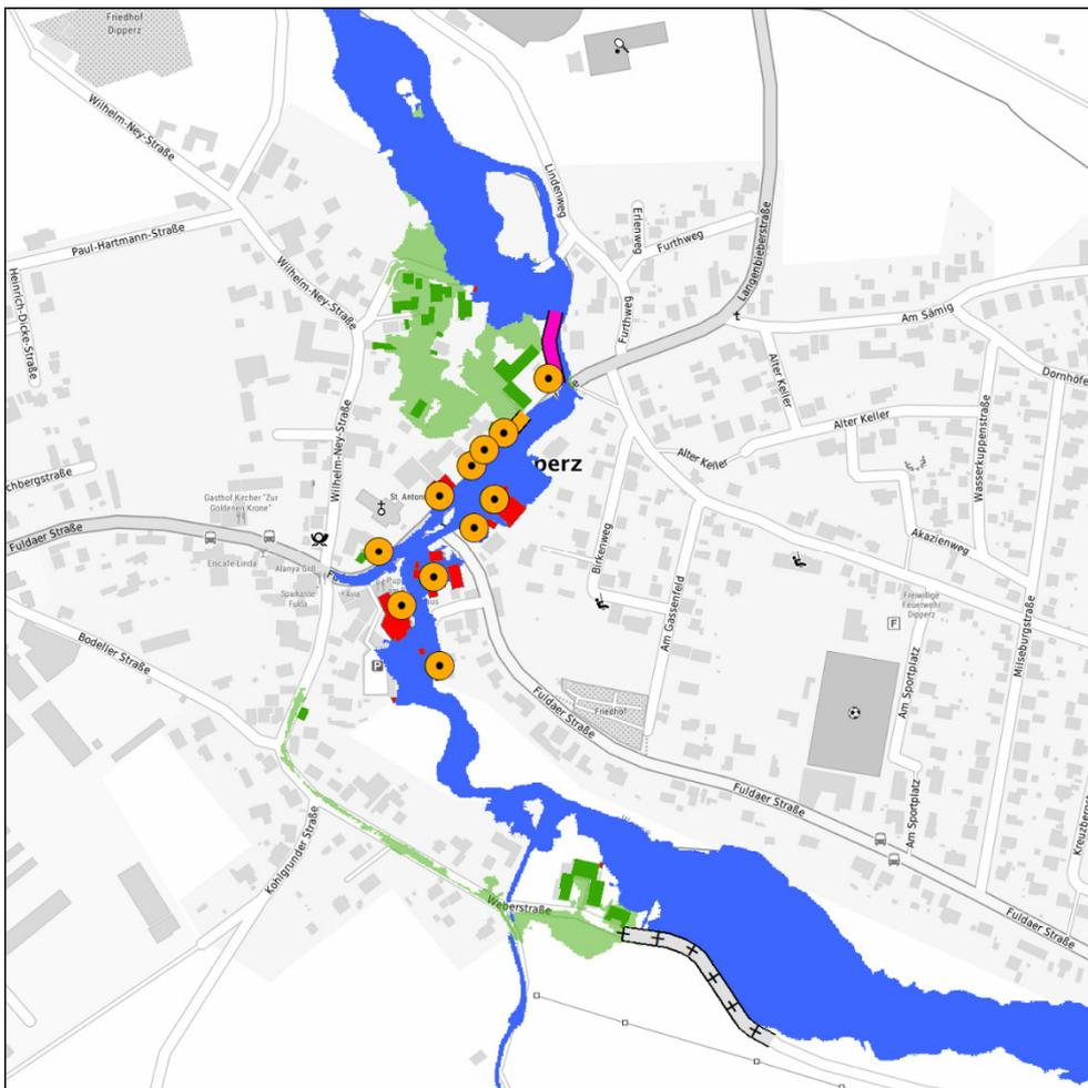
**Abbildung 11-33: Überflutungsfläche HQ100 für Grundvariante 2 in Dipperz**
