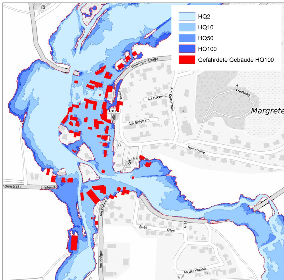
**Abbildung 11-11: Überflutungsflächen HQ(T) für den Istzustand in Margrethenhaun**
