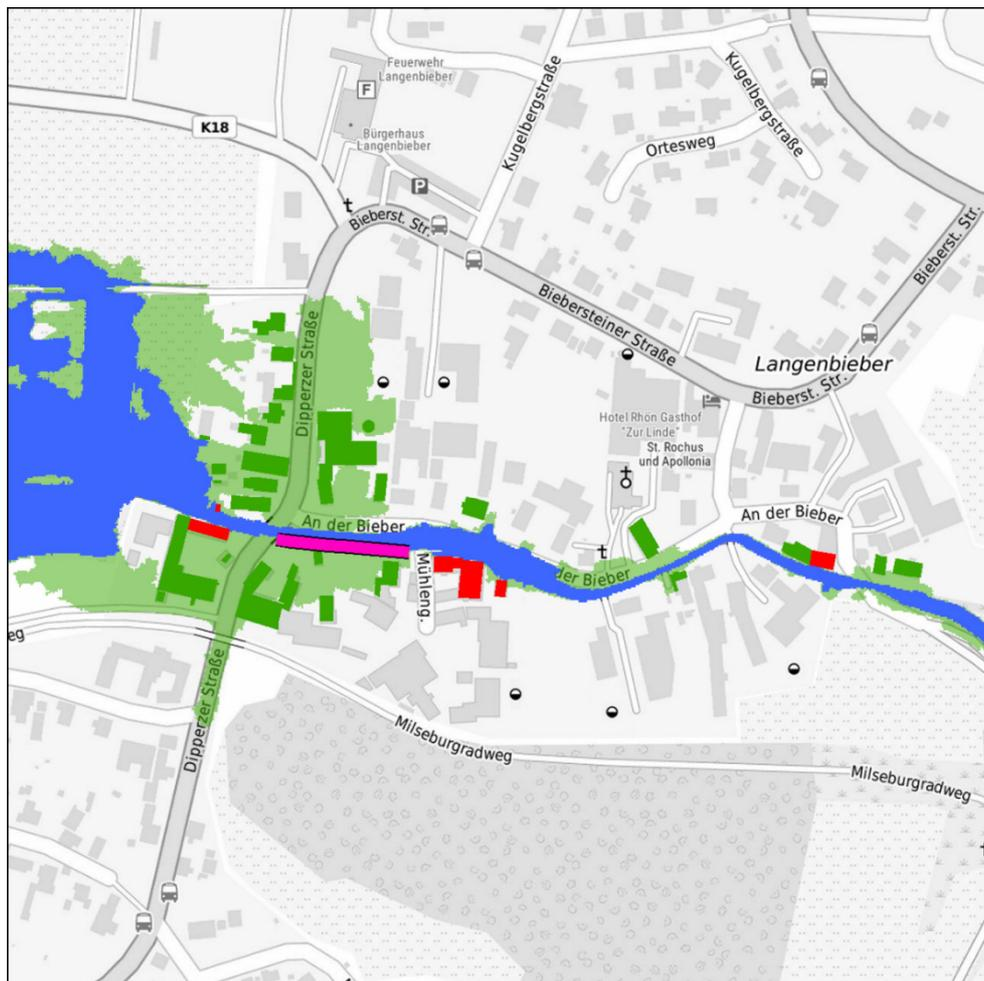
**Abbildung 11-46: Überflutungsfläche HQ100 für die Vorzugsvariante in Langenbieber**
