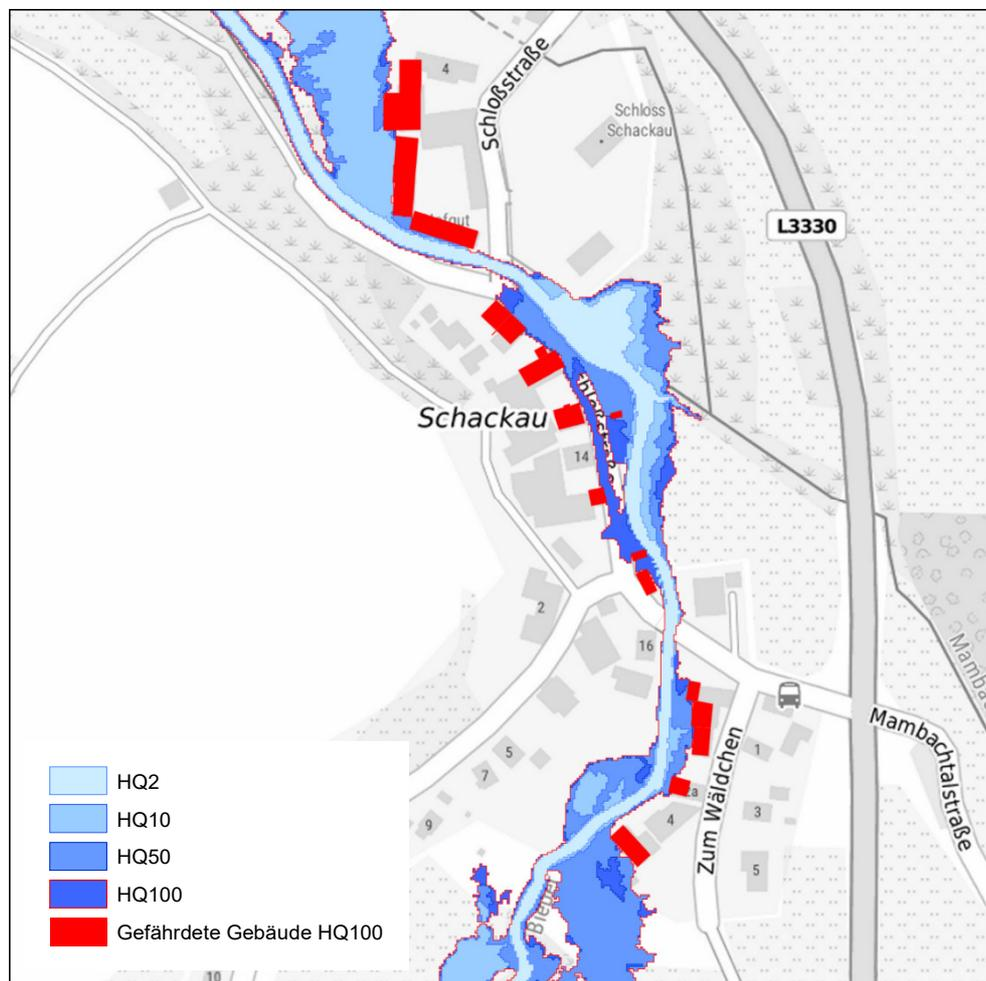
**Abbildung 11-47: Überflutungsflächen HQ(T) für den Istzustand in Schackau**
