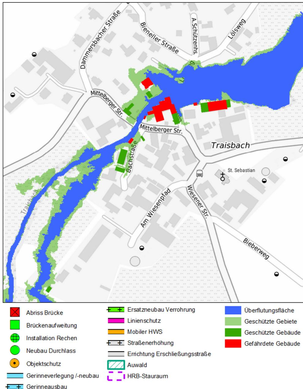
**Abbildung 11-57: Überflutungsfläche HQ100 für Grundvariante 1 in Traisbach**
