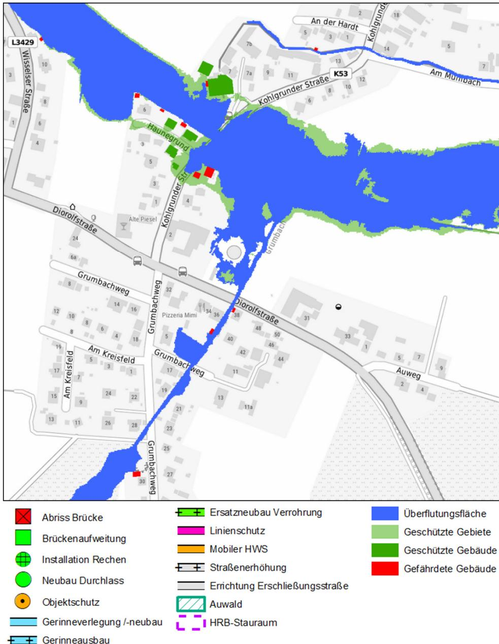
**Abbildung 11-26: Überflutungsfläche HQ100 für Grundvariante 1 in Dirlos**
