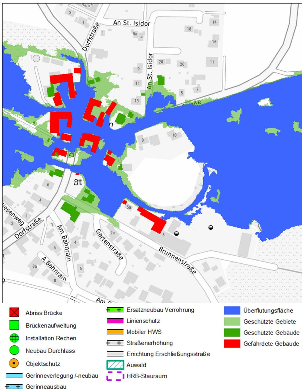
Abbildung 11-36: Überflutungsfläche HQ100 für Grundvariante 1 in Wiesen
