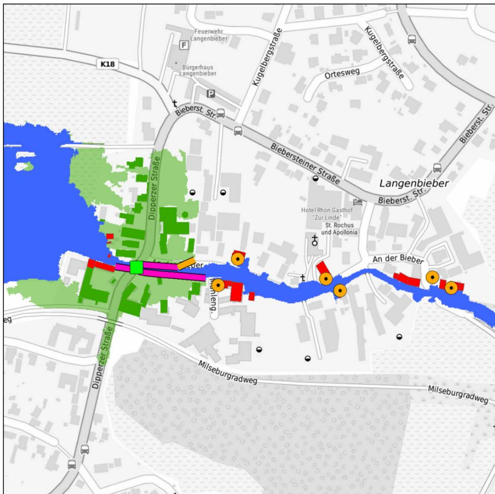
**Abbildung 11-45: Überflutungsfläche HQ100 für Grundvariante 2 in Langenbieber**
