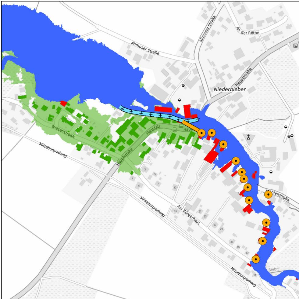
**Abbildung 11-41: Überflutungsfläche HQ100 für Grundvariante 2 in Niederbieber**
