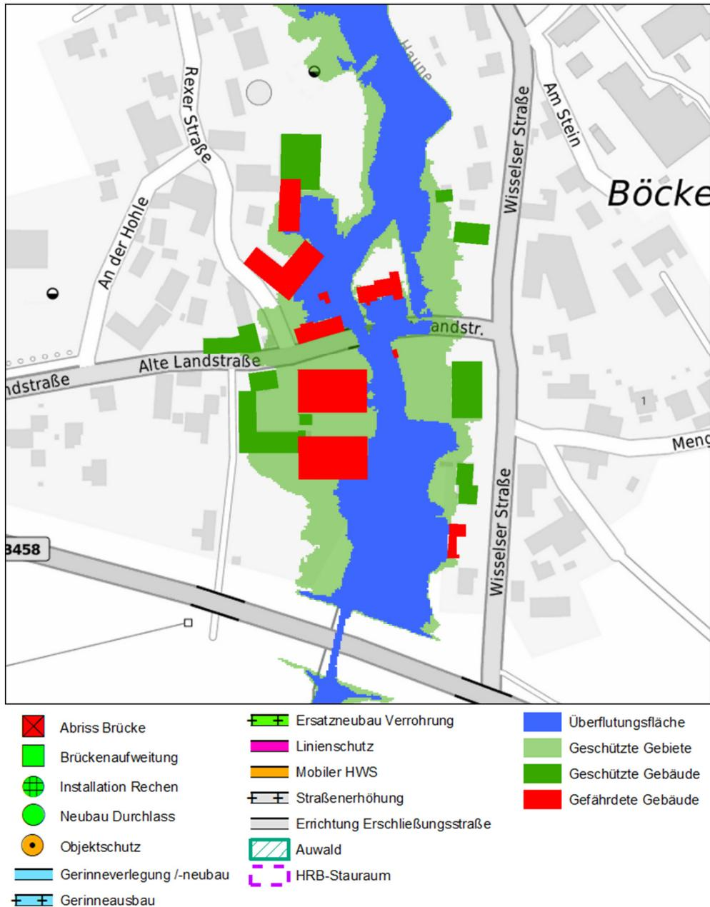
**Abbildung 11-19: Überflutungsfläche HQ100 für Grundvariante 1 in Bökels**
