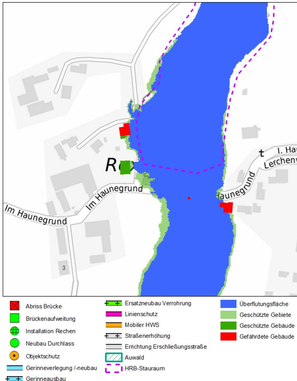
**Abbildung 11-16: Überflutungsfläche HQ100 für Grundvariante 1 in Rex**
