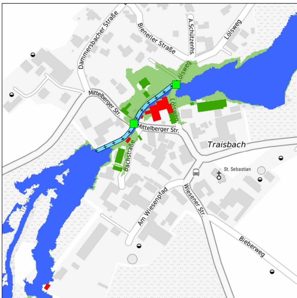
**Abbildung 11-58: Überflutungsfläche HQ100 für Grundvariante 2 in Traisbach**
