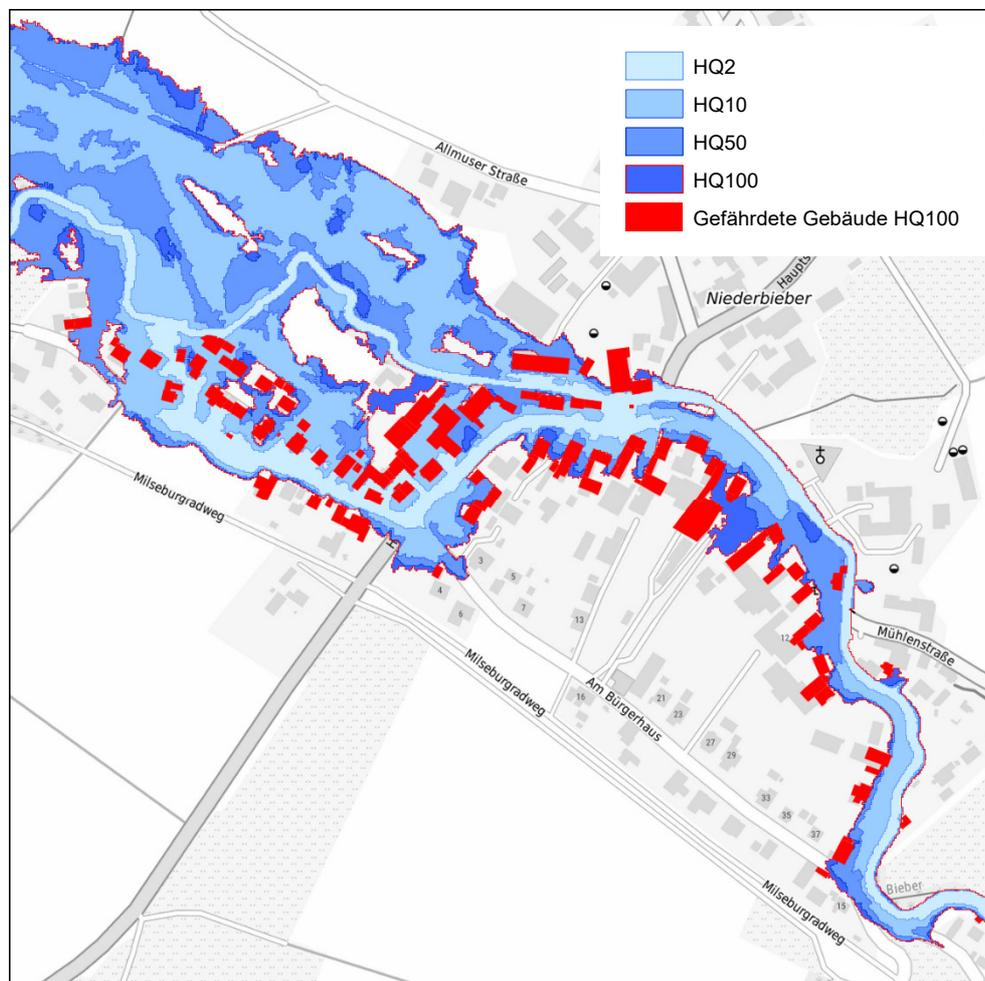
**Abbildung 11-39: Überflutungsflächen HQ(T) für den Istzustand in Niederbieber**
