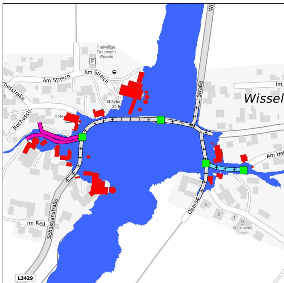
**Abbildung 11-23: Überflutungsfläche HQ100 für Grundvariante 2 in Wissels**
