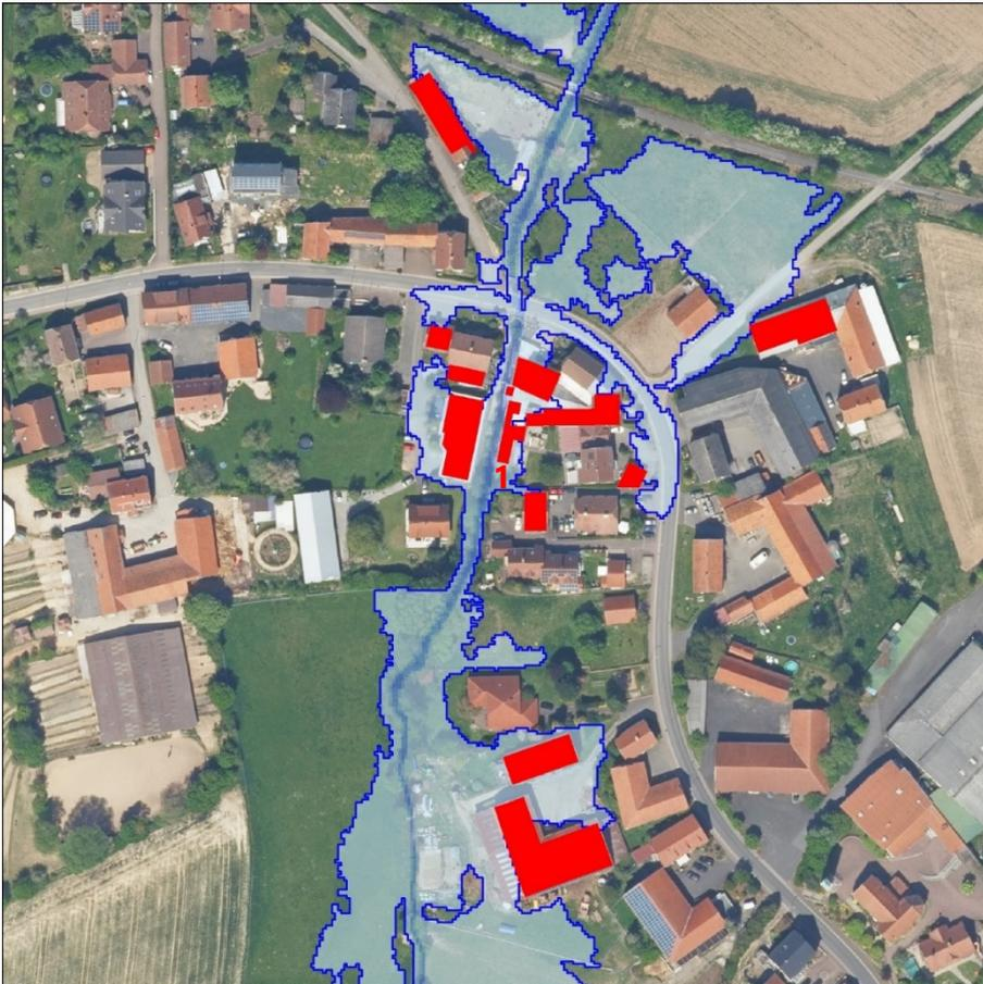
**Abbildung 7-10: Modellierte Überflutungsflächen HQ10 in Almendorf**
