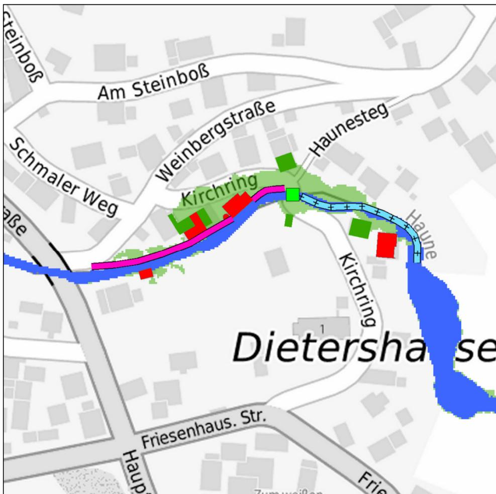
**Abbildung 11-30: Überflutungsfläche HQ100 für Grundvariante 2 (Vorzugsvariante) in Dietershausen**
