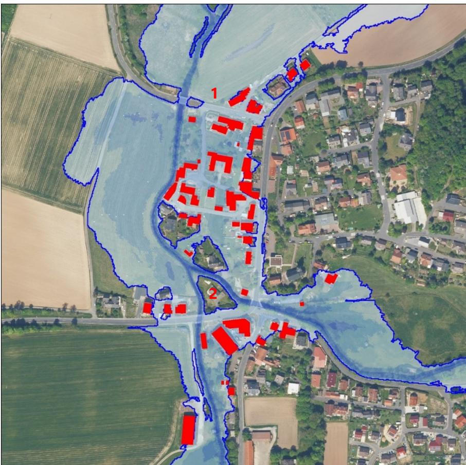
**Abbildung 7-5: Modellerte Überflutungsflächen HQ50 in Margrethenhaun**
