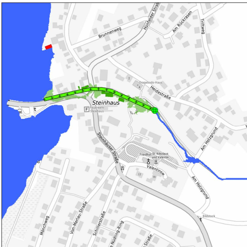
**Abbildung 11-3: Überflutungsfläche HQ100 für Grundvariante 2 (Vorzugsvariante) in Steinhaus**
