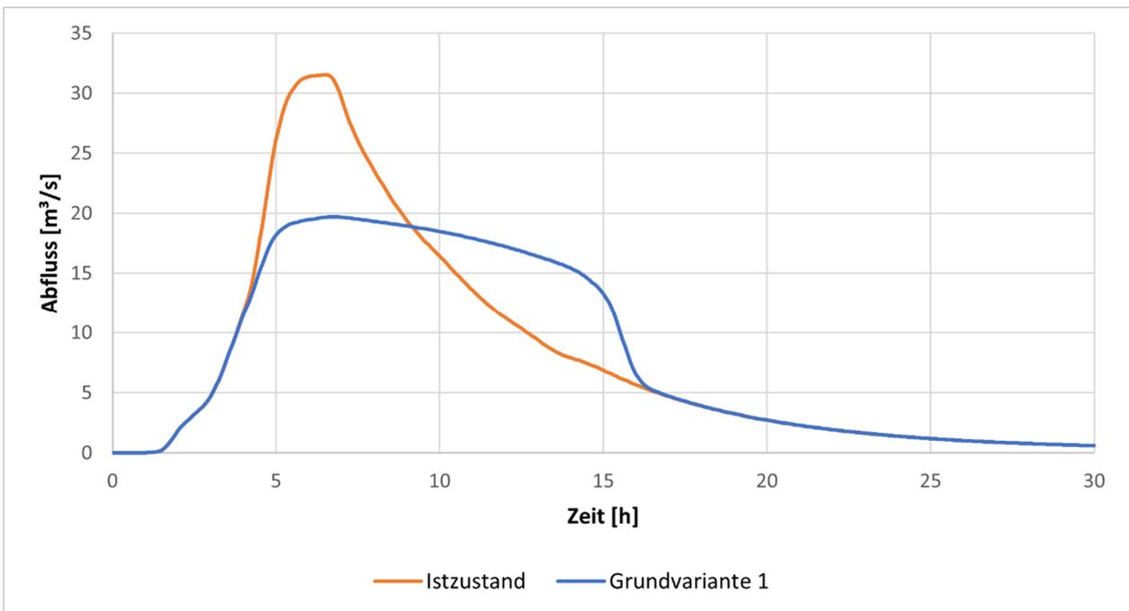
**Abbildung 9-5: Abflussganglinie HQ100 für Istzustand und Grundvariante 1 an der Bieber stromoberhalb Mündung in Haune**
