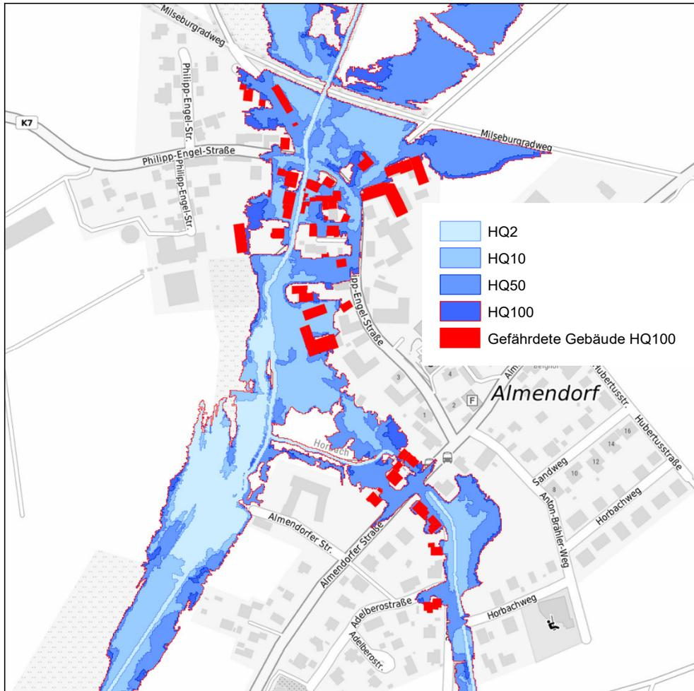
**Abbildung 11-4: Überflutungsflächen HQ(T) für den Istzustand in Almendorf**
